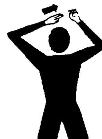
**GROUND ELECTRICAL POWER SUPPLY DISCONNECT**
