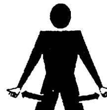
**GROUND ELECTRICAL POWER SUPPLY INSERT**
